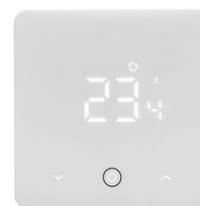
Sensore di temperatura e umidità
